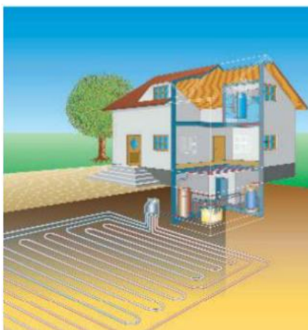
Abb. 5.10: Systeme der Energiegewinnung im Rahmen der Nutzung oberflächennaher Geothermie (Quelle: BAYERISCHES STAATSMINISTERIUM FÜR UMWELT; GESUNDHEIT UND VERBRAUCHERSCHUTZ 2007)
